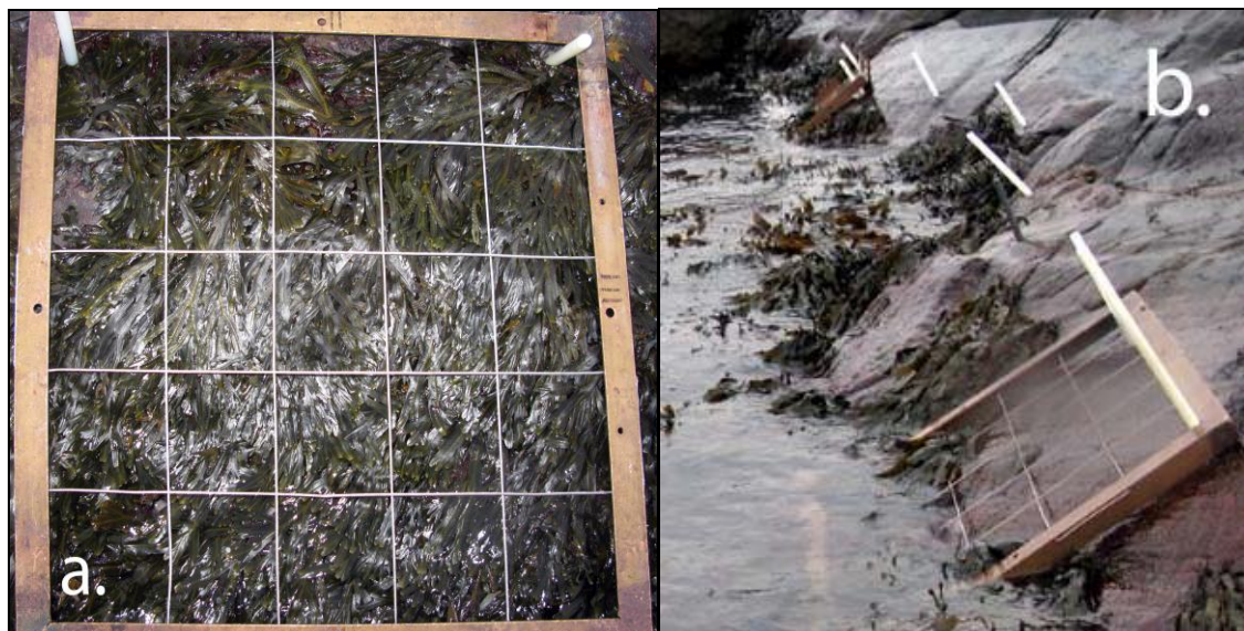
Figur 2. a. Ramme (0,5 x 0,5 m) inndelt i 25 hjelperuter (10 x 10 cm). b. 4 rammestasjoner merket med bolter i fjellet. Boltene blir fjernet mellom hver undersøkelse.
