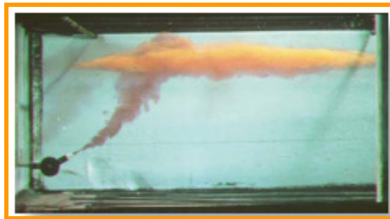
Figur 11. Foto fra laboratorieforsøk med oppstigende (lett, ferskt) farget vann i en sjiktet væske (sjøvann).
