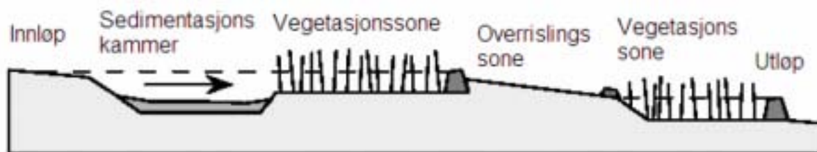
Figur 26. Oppbygning av en fangdam etter Bioforsk Tema 3 (13), 2008.
