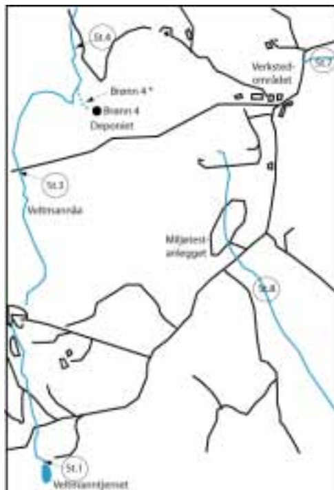
Figur 1. Bradalsmyra testsenter med veinett, bekker og prøvetakningspunktene i Veltmannåa (St.1, 3 og 4), fra verkstedsområdet (st. 7) og miljøtestsenteret (st. 8), samt i grunnvannet nedstrøms deponiet (Brønn 4) som er nærmest Veltmannåa. Den gikk tett i 2011 og nytt prøvepunkt (brønn 4*), som er et grunnvannsig som kommer ut i dagen 15 m nedenfor brønn4, ble brukt som alternativt målepunkt.
