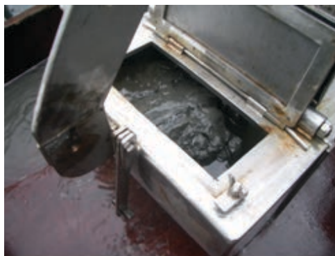
Figur 5. Foto av van Veen grabb med inspeksjonsluke.
