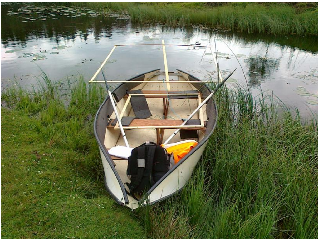
Figur 7. Rammer laget av lekter hhv 2x2 m og 1x1m som ble benyttet for å estimere tetthet og biomasse. Rammene ble kastet «tilfeldige steder» ut fra båten gjentakende ganger etter at man hadde rodd ti åretak, og vannplanter av ulike slag innen rammen ble talt opp.
