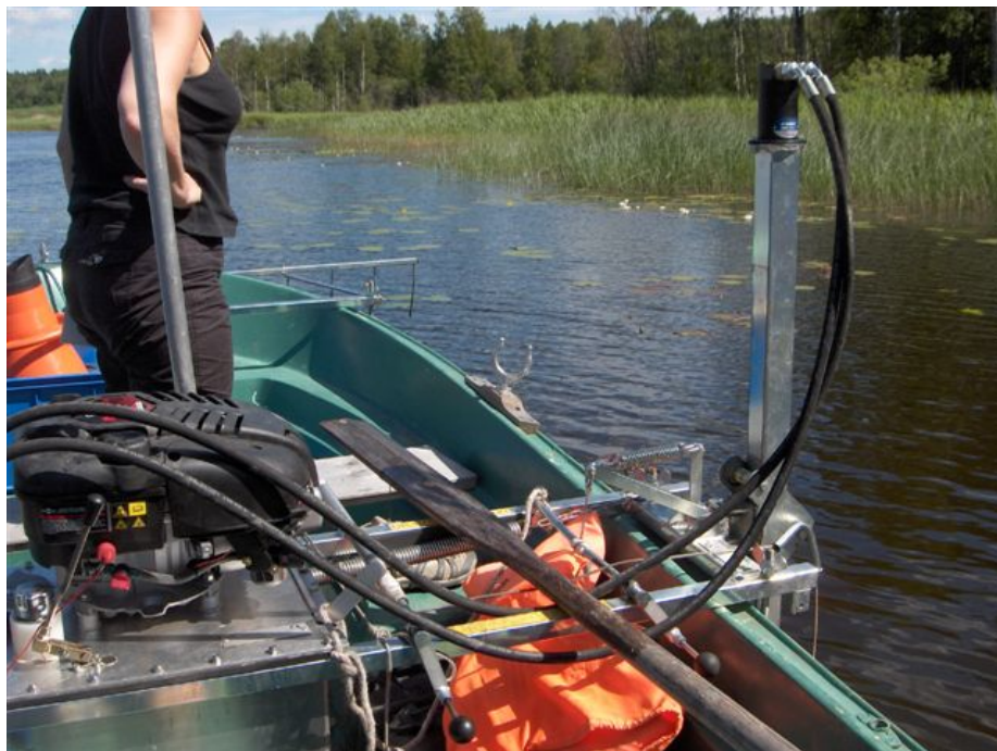
Figur 4. Kutting av vannliljer Et hydraulikk aggregat driver en nedsenkbar slåmaskinkniv.
