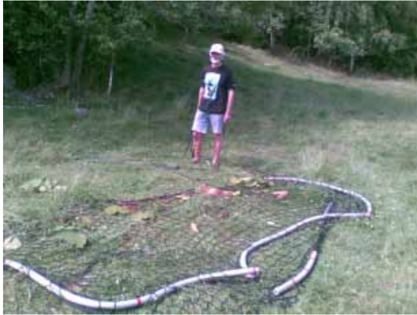
Figur 6. Etter at vegetasjonen er dyttet til land med riva foran på båten, trekkes den på land ved hjelp av en not laget av «fotballmålnetting». Overtendelens flottør er polyetylenskumstrømper egentlig laget for isolasjon av vannrør.
