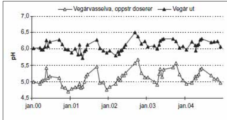
Figur 10. Resultat av pH-målingar i Vegårvasselva ovanfor doserer og i utløpet av Vegår (Utsnitt frå Kaste & Skancke 2005).
