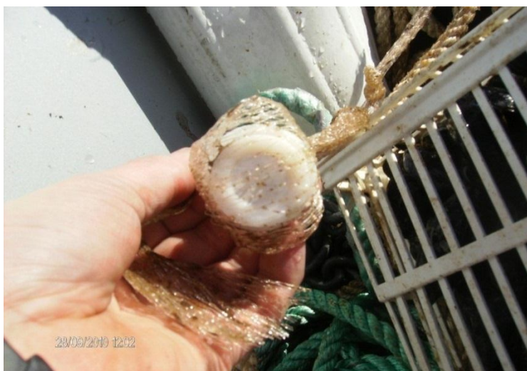
Figur 7. Opptak av passiv prøvetaker for metaller (DGT) (Foto: Ian Allan).
