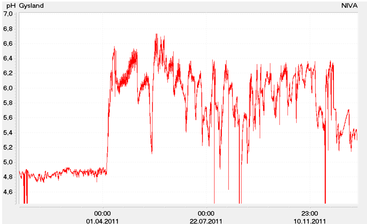
Figur 2. pH oppstrøms Gysland doseringsanlegg. Det var stor variasjon i pH, selv etter at anlegget på Birkeland ble satt i drift 2. mai. De lave verdiene om vinteren er ikke reelle. Årsaken var stopp i vanngjennomstrømmingen av pH-kyvetten på grunn av defekt inntak fra elva.
