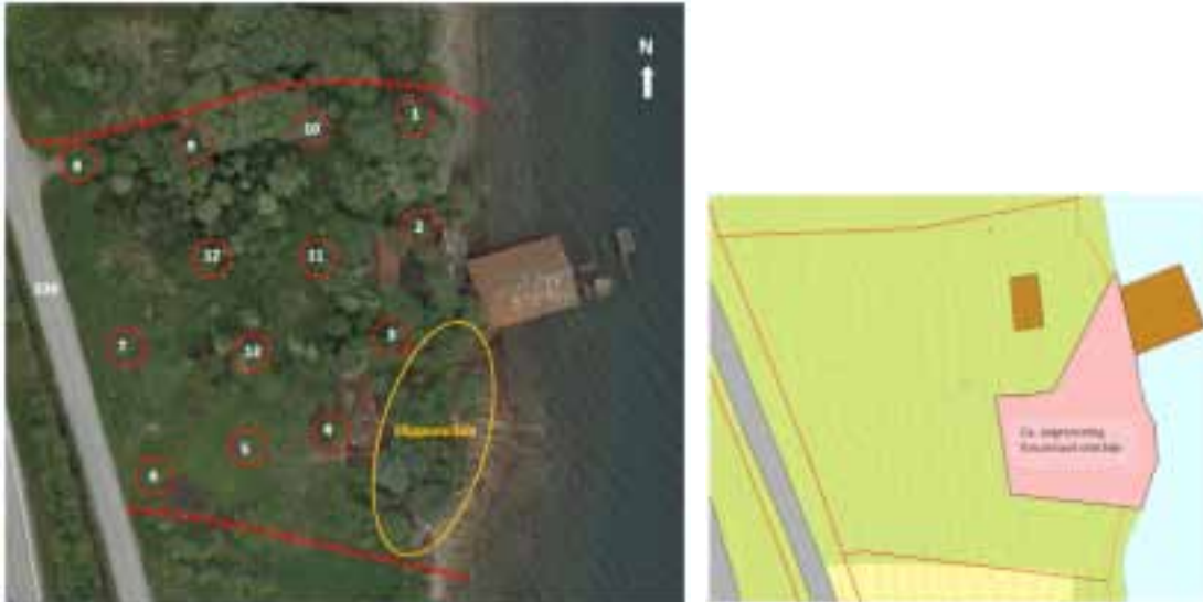
Figur 4: Flyfoto med (a) avgrensning av tømten og (b) plassering av punkter for den supplerende undersøkelsen. Den ferdige undersøkelsen basert på ovenstående prøver i slippsområdet.
