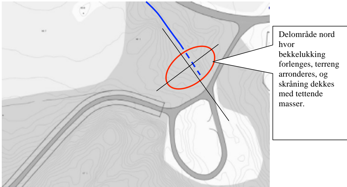
Figur 6. Tiltak nord for innkjøringsvei
