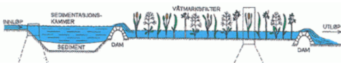
Figur 21. Fangdam bestående av sedimentasjonskammer og våtmarksfilter (Bioforsk 2004).
