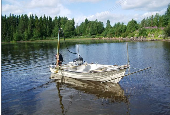
1. Klipperen "Hymo" er beregnet til å sette på lett-båt
