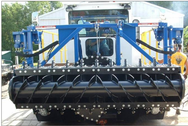
1. Mud Cat mudringsmaskin påmontert et spesialhode for vegetasjonshøsting
