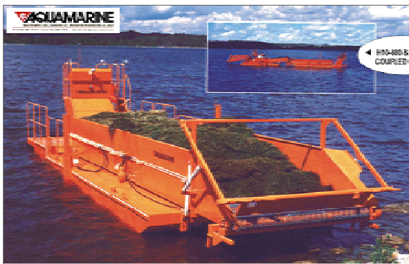
3. En egen selvgående lekter for i landkjøring av det høstede materiale. Legg merke til at lekteren er koplet til høstemaskinen i det innfeldte bildet. Bunnen av høstemaskinen og lekteren er utstyrt med transportbånd, slik at lasting og lossing går på få minutter.
