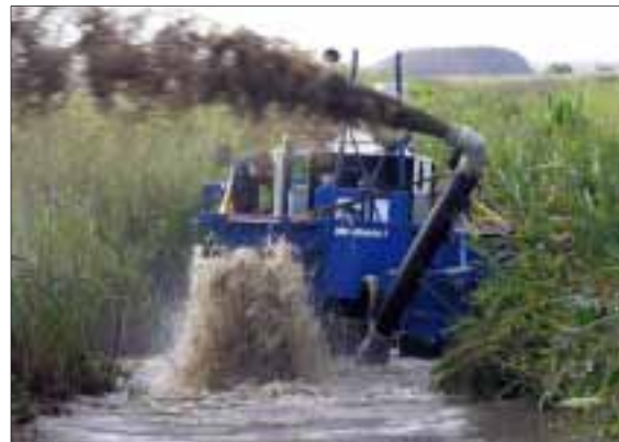
2. Materialet kan sprutes eller pumpes på land eller til en avvanningslekter
