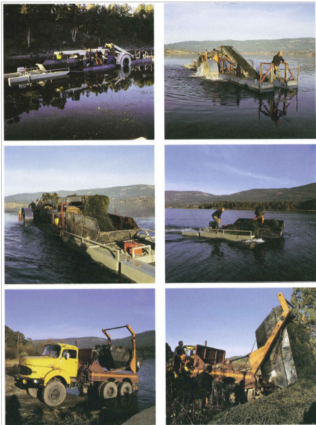
Figur 19. Vasspesthøsting i Steinsfjorden med maskinen «Slurpen». Skjærehodet består av to vertikale og en horisontal slåmaskinkniv. Et transportbånd av netting fører vegetasjonen opp av vannet, over båten og ned i en container som henger bak. En «supply-båt» kan henge på en ny container og transportere den høstede vegetasjonen til land der det hentes av en bil med container-lift. Maskinen kan høste kontinuerlig uten å måtte avbryte arbeidet for å transportere plantemateriale til land (Berge et al 1989). Alle fotos: Dag Berge.
