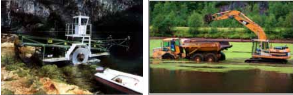
Figur 20. Venstre: En Watermaster RS 2000 (finsk-produsert) ble benyttet av Krypsivprosjektet i 1996. Høyre: Gravemaskin er også benyttet for å ta opp krypsiv. Fotos: B. Rørslett (venstre bilde) og http://vestagder.miljostatus.no (høyre bilde).
