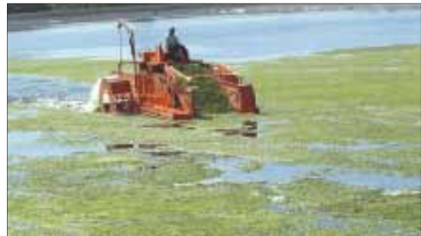
2. Aquamarine maskin under høsting av Hydrilla verticillata , en vasspestliknende plante
