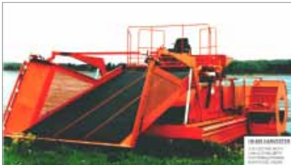
1. Høstingsmaskin fra Aquamarine USA. Skjærebord bestående av to vertikale og en horisontal slåmaskin-kniv. Plantene transporteres opp av vannet ved et nettingtransportbånd. Fremdriften er skovlehjul.
