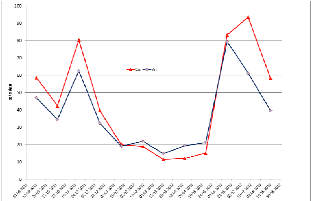
Figur 11. Momentan transport av kobber og sink i Grunnstollen i 2011-2012.
