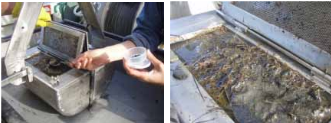
Figur 3. Bunnprøver fra lokalteten K42 ved utslippsstedet for Otraledningen 27. mai 2008. Venstre: Grabb med inspeksjonsluker åpnet for uttak av overflatesediment til analyse. Høyre: nærfoto av åpnet inspeksjonsluke som viser tett dekke av død krypsiv på bunnoverflaten.
