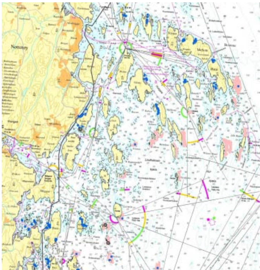
Figur 15. Oversikt over verifiserte forekomster av modellert skjellsand i den nordlige delen av utredningsområdet. Blå punkter viser fravær av skjellsand på feltregistrerte punkter, og grå punkter viser tilstedeværelse av skjellsand. Rosa bakgrunn er modellert skjellsand. Målestokk 1:50 000.
