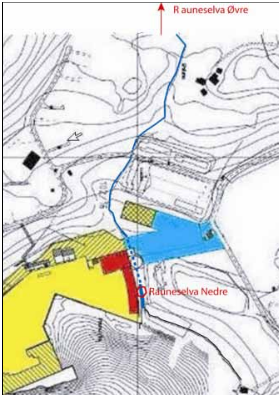
Figur 3. Nedre del av Rauneselva gjennom mottaksanlegget. Nedre stasjon for prøvetaking er vist. Øvre stasjon ligger utenfor mottaksområdet og kartet. Kartgrunlaget er fra AF Miljøbase Vats, Områdeinndeling. De gule arealene er arealklasse B (asfalt med membran; skravert gul er asfalt uten membran), og røde arealer er arealklasse A (mest omfattende sikringstiltak mot avrenning av miljøgifter). Arealer farget blått er arealklasse C (uten spesielle rensekrav for avrenning).
