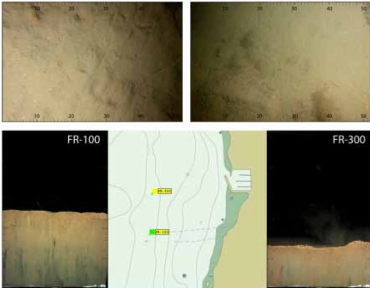
Figur 6. Fuglevik rensanlegg. Kart med undersøkte stasjoner, posisjon (grønn sirkel), status (kvadrat), Sediment-overflatebilde (SSI) og sedimentprofilbilde (SPI) fra stasjon FR-100 (t.v.) og FR-300 (t.h.).
