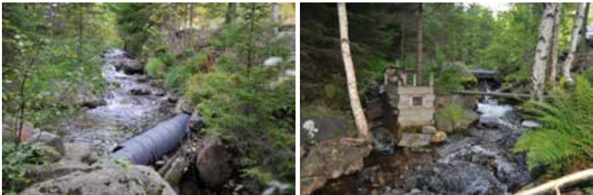
Figur 7. Venstre: plastrør plassert i bekken som leder ål inn i transportkanal og fram til fangstkista. Høyre: Fangstkiste for fangst av nedvandrende ål i Sagebekken. Foto: F. Kroglund
