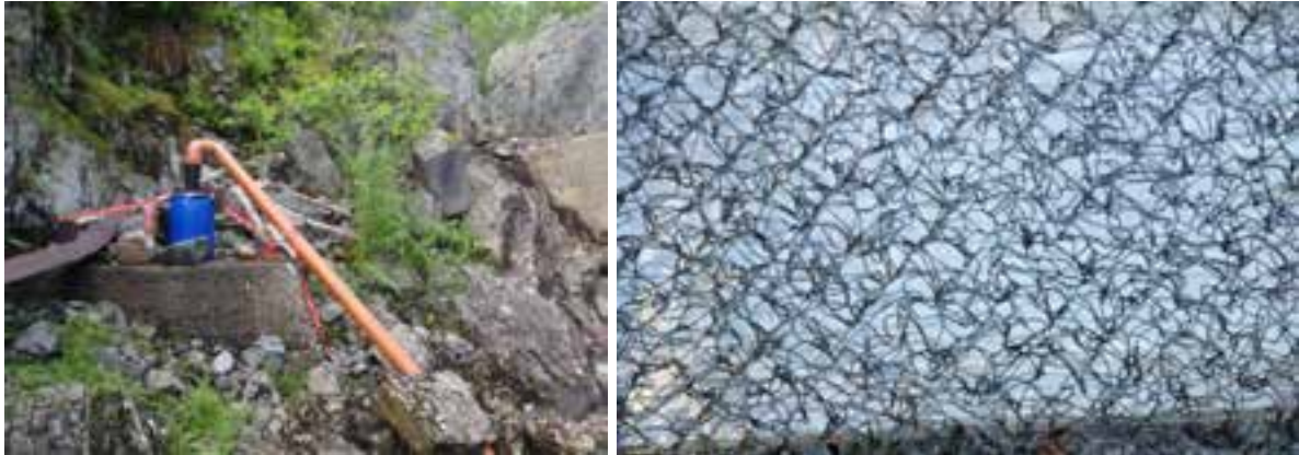
Figur 9. Oppvandringsfelle for ål plassert ved inngangen til nedre laksetrapp ved Fosstveit kraftverk (venstre foto). Enkammat (vevde plasstråder, høyre foto) ble lagt inn i røret for å hjelpe ålen med å vandre opp i fella. Foto: F. Kroglund
