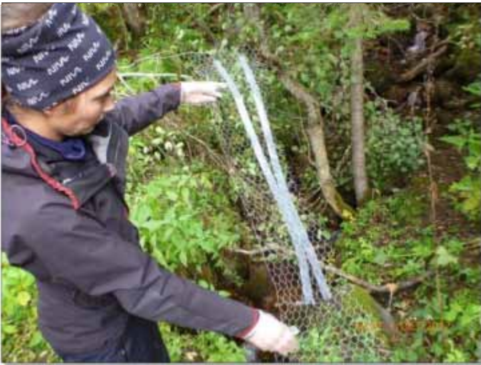
Figur 1: Montering av passive prøvetakere på hønsenetting (foto: Morten André Bergan).
