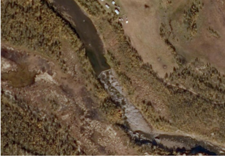
Figur 16. Eksempel på terskel i vannforekomsten, som ikke ser ut til å ivareta økologisk kontinuitet for laksefisk. (Flyfoto hentet fra http://kart.finn.no/ )
