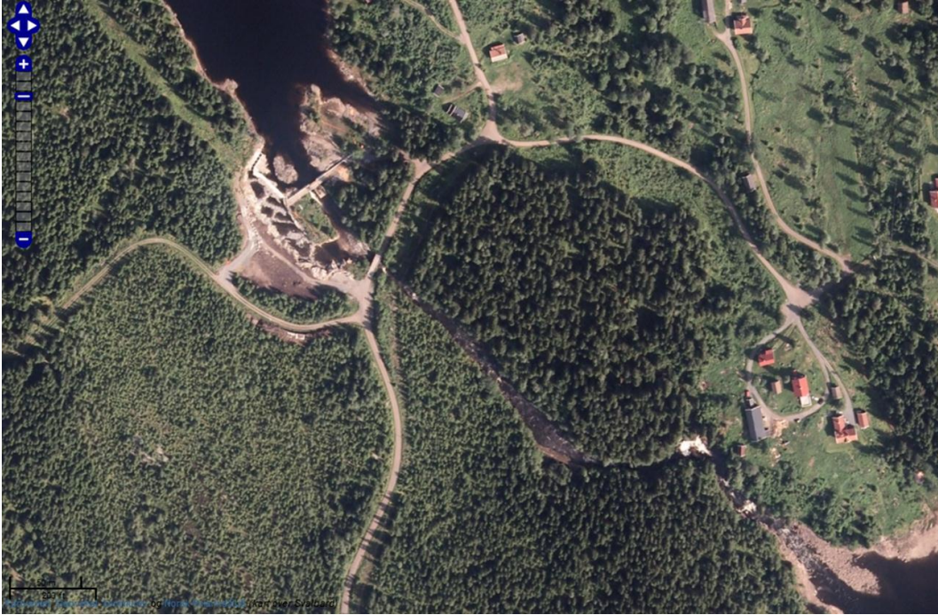
Figur 96. Den nye utløpsanordningen fra Sandungen gjør at fisk lettere kan vandre mellom Katnosa og Sandungen. Den nye fisketrappa øverst til venstre. Hakloa gård og Hakloa nederst til høyre (fra kartverkets Norge i bilder).
