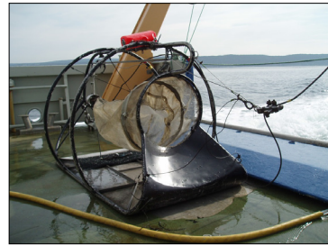
Figur 23. Slede brukt til fangst av reker langs bunnen i dypområdene i Indre Oslofjord (Foto: J. A. Berge)
