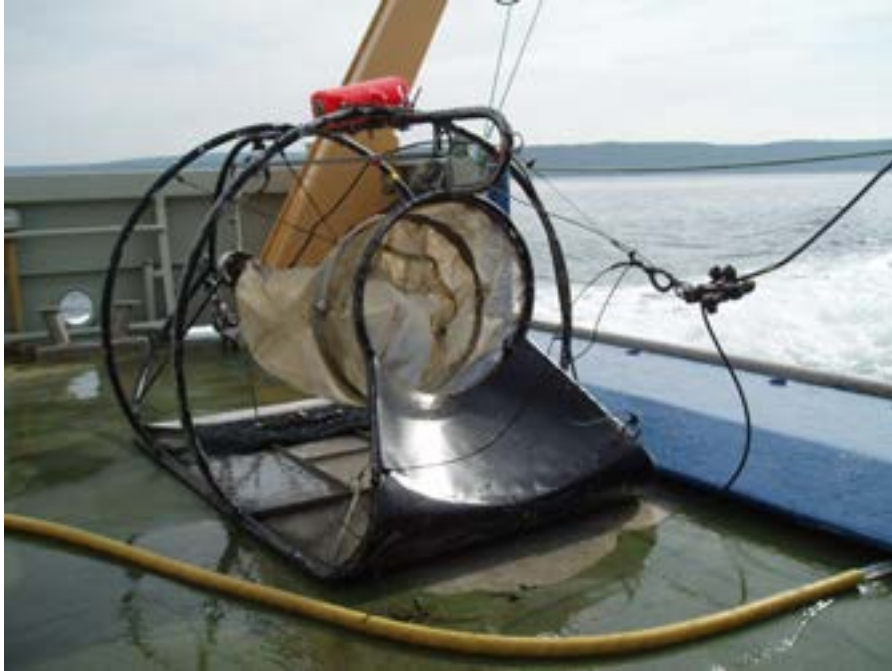
Figur 74. Slede brukt til fangst av reker langs bunnen i dypområdene i Indre Oslofjord (Foto: J. A. Berge)
