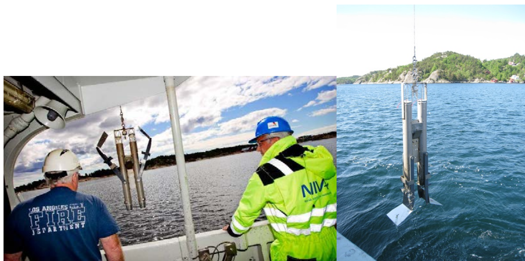
Figur 7. Prøvetaking av sedimenter med dobbel kjerneprøvetaker (Foto: Torstein Øen, Fædrelandsvennen, og Sigurd Øxnevad).
