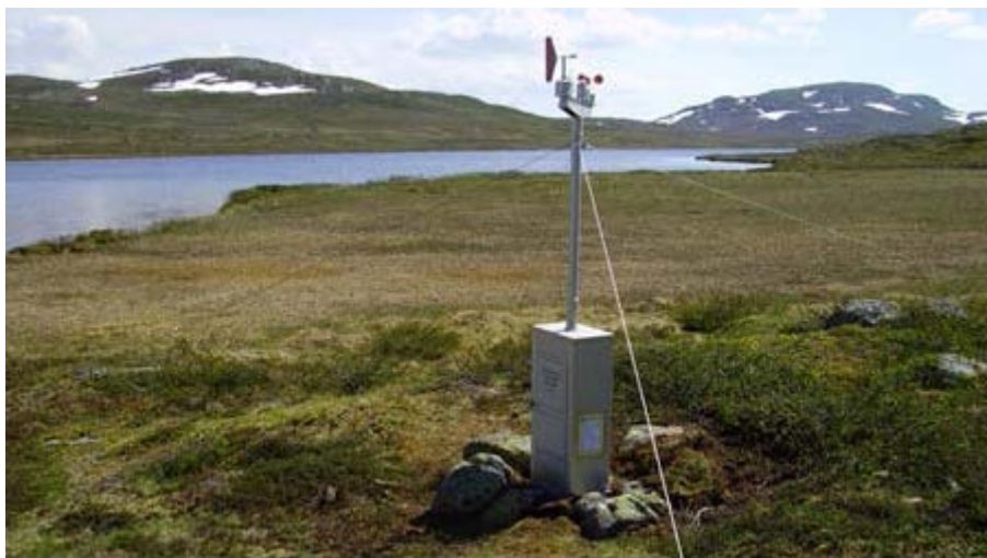
Figur 5. Værstasjonen som ble satt opp ved Dargesjøen for å kalibrere værdata mot de nærmeste meteorologiske stasjonene Geilostølen (fra 2006 Olderbråten) og Møsstrand.
