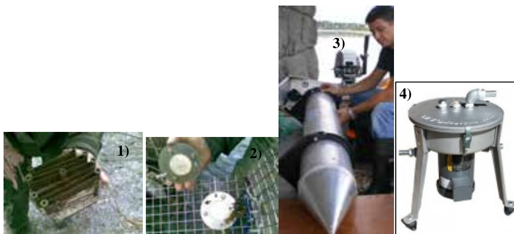
Figur 1. Ulike typer passive prøvetakere av typen 1) SPMD (semipermeable membran device) og 2) POCIS (polar organic chemical integrative sampler), samt høyvolumsprøvetakere 3) sedimentfelle og 4) kontinuerlig vannstrømssentrifuge (vann pumpes fra peristaltisk pumpe til sentrifuge som roterer).
