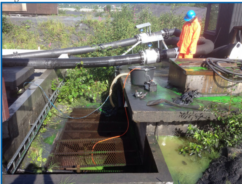
Figur 7. Dosering av sporstoffet (fortynna til 1:10) frå 50 liters stamp gjennom slange.
