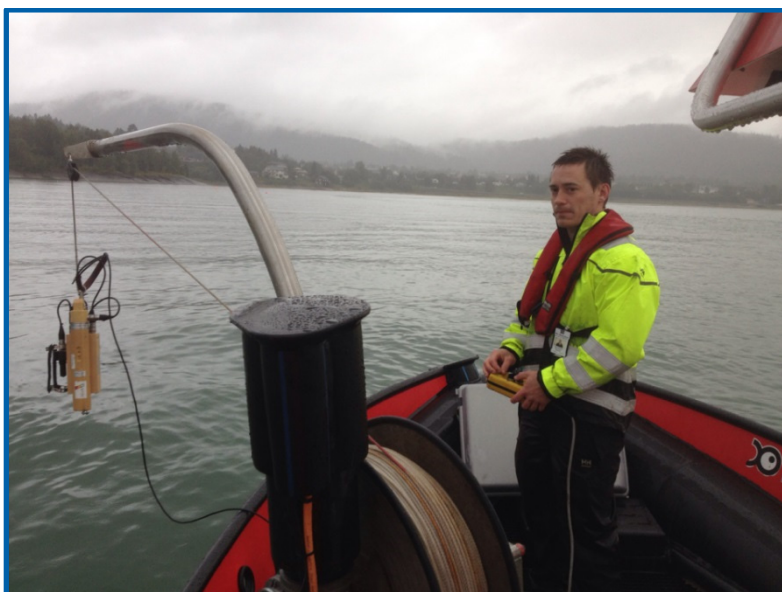
Figur 8. Vinsjoperatør om bord i båten, med elektrisk vinsj og SAIV sonden hengande i daviten, klar for nedsenking.
