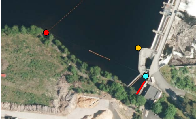
Figur 19. Utsettingslokalitet ved Rygene. Fra rød prikk er det ca. 100 m til varegrinda, mens det er ca. 32 m fra oransje prikk. Varegrinda er antydnet med rød strek og isluka med blå prikk. Det avlange streket i inntaksområdet er PIT antenna før denne fikk sin endelige plass (foto fra Norge i bilder).
