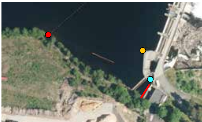
Figur 19. Utsettingslokalitet ved Rygene. Fra rød prikk er det ca. 100 m til varegrinda, mens det er ca. 32 m fra oransje prikk. Varegrinda er antydnet med rød strek og isluke med blå prikk. Det avlange streket i inntaksområdet er PIT antenne før denne fikk sin endelige plass (foto fra Norge i bilder).
