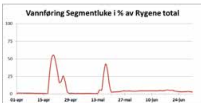
Figur 23. Prosentandel av vannføringen målt ved Rygene som gikk ut segmentluke 3 (+miniaggregatet). Vannføring her er beregnet ut fra vannføring angitt som "Rygene total" fratrukket 170 m 3 /s (slukeevnen til turbinen) og 5 m 3 /s (vann brukt sideløpet).
