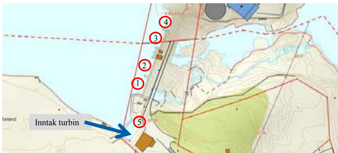
Figur 3. Kart som viser damområdet ved Rygene kraftverk. Inntak turbin samt segmentluke 1 til 3 og klappluke 4 er markert. Isluka er angitt som punkt 5. Laksetrappa fremgår som tynn blå "elv" nedstrøms kraftverket. Kart fra Kystverket.no.
