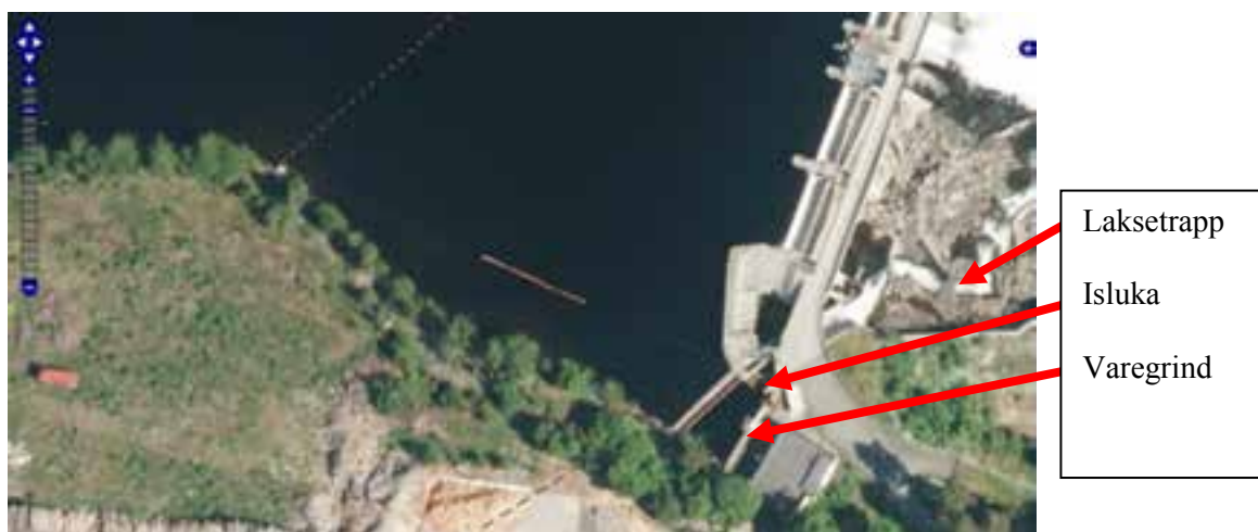
Figur 9. Tiltaket benyttet ved Rygene innbefatter bruk av varegrinda (atferdssperre), og isløpet.
