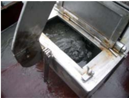
Figur 4. van Veen grabb med inspeksjonsluke.
