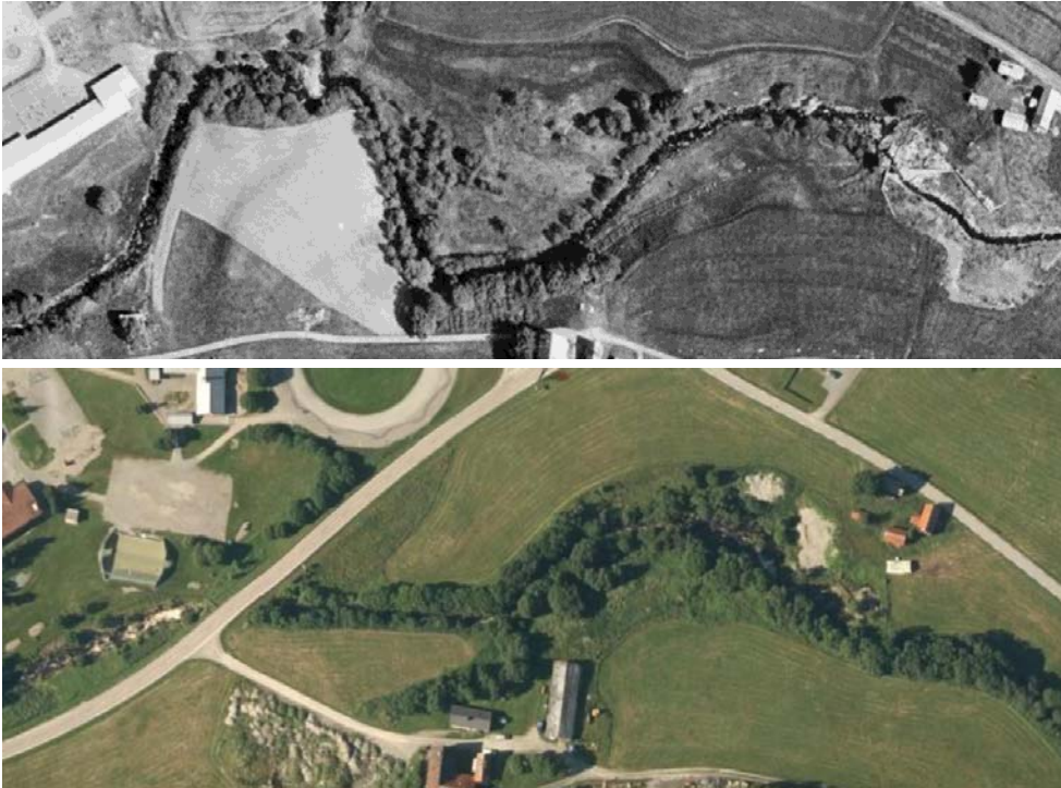
Figur 41. Flyfoto fra 1969 (øverst) sammenlignet med tilsvarende foto fra 2011 (nederst) viser tap av \pm 100-150 meter elvestrekning i Bottengårdselva (Kartgrunnlag: http://kart.finn.no/ )
