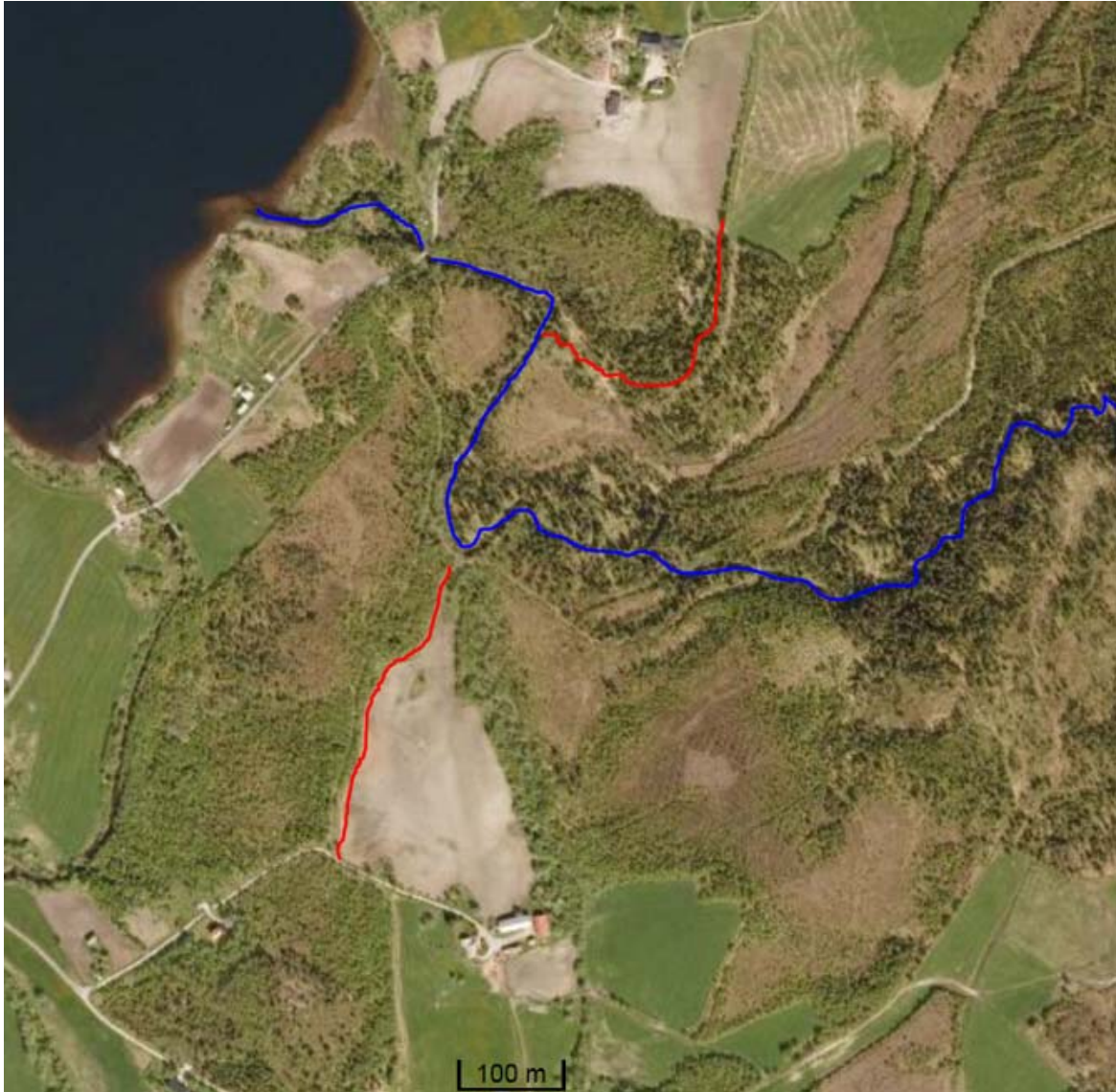
Figur 40. Potensielle avrenningskilder (rødt) som kan være årsaken til forhøyde bakterienivåer i Djupeelvas (blått) nedre del. (Kartgrunnlag: http://kart.finn.no/ )
