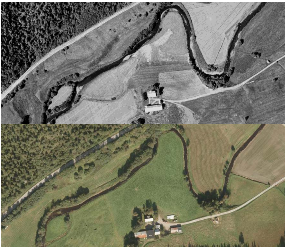
Figur 19. Utsnitt av Flytelva. Elva er utrettet og inn-smalnet av nærliggende landbruksvirksomhet sammenlignet med tidligere naturtilstand, og sideløp er lukket og meandersvinger er fjernet. Inngrepene har redusert vannforekomstens areal, arealkvalitet og produksjonskapasitet for laksefisk. Flyfoto fra 1965 (øverst) og fra 2009 (nederst). Kilde: http://kart.finn.no/
