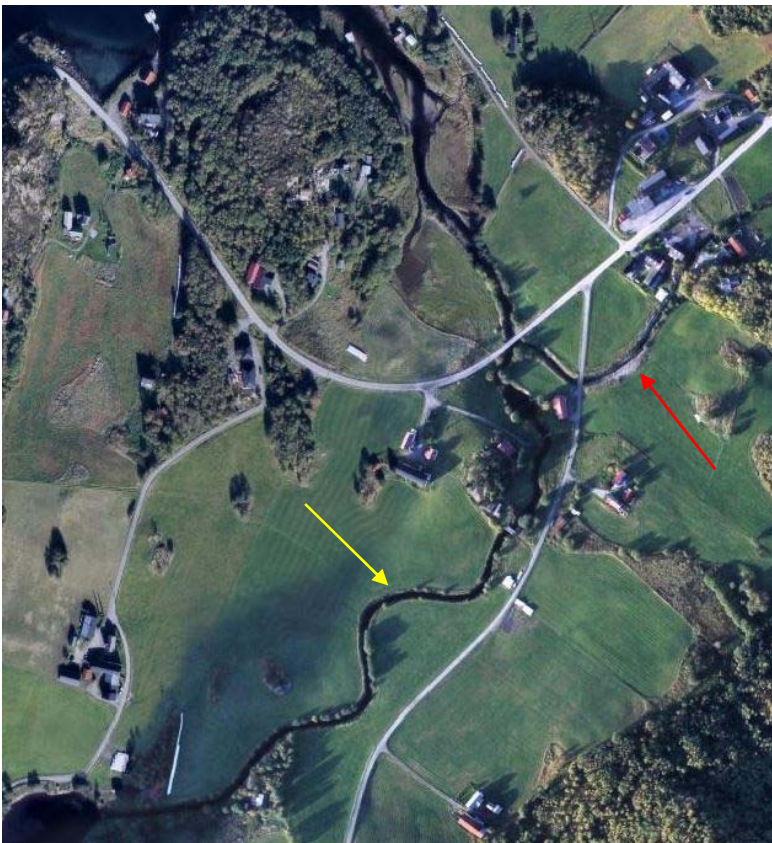
Figur 75. Flyfoto (2008) fra Straumselva (gul pil) og Kvernelva (rød pil). Betydelig utrettet og endret elve- og bekkeløp, og ikke ubetydelig reduksjon i opprinnelig habitatkvalitet, areal og produksjon av anadrom laksefisk, sammenlignet med naturtilstand. Flyfoto hentet fra http://kart.finn.no/ .
