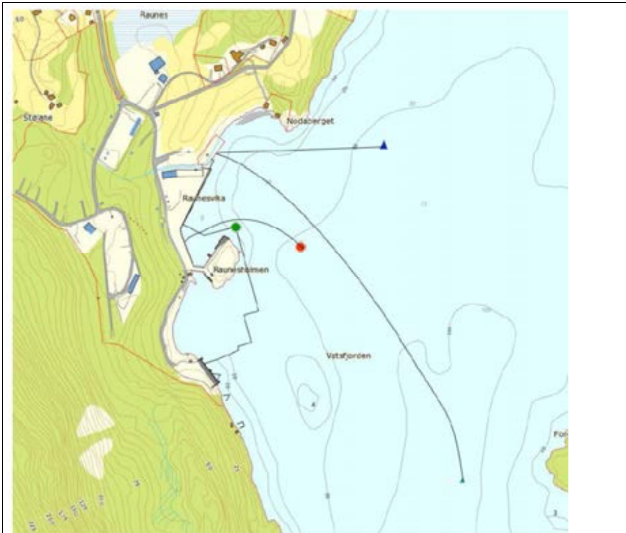
Figur 3. Oversiktskart hvor utslippspunktene for avløpsvann uten for Rauneskaien og posisjonene for inntaksvannet til Raunes Fiskefarm er tegnet inn. Den røde sirkelen markerer utslippspunktet for det kommunale kloakkutslippet. Den grønne sirkelen er utslippspunktet fra miljøbasens rensanlegg. Den lille blå trekanten er inntaksstedet for sjøvann til Raunes Fiskefarm i 2010, mens den store blå trekanten markerer inntakspunktet for planlagt ny inntaksledning til fiskefarmen etter konsesjonen. Figuren er hentet fra Kvassnes m. fl. 2010b (Modelleringsforsøk).
