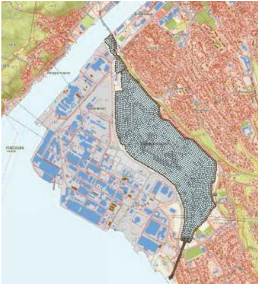
Figur 6. Nettverket eller gridet i RMA2-modellen for simulering av sirkulasjon. I hvert hjørne av trekantene og midt på hver side (noder) beregnes høyden over referansedypet, strømretning og strømhastighet.
