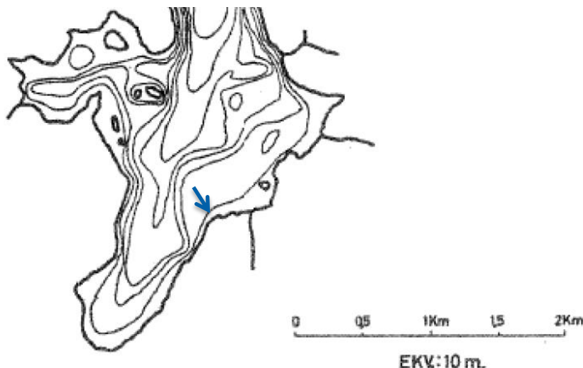
Figur 3. Dybdekart for den sørlige delen av Rore, med posisjon for Grimstad vannverk indikert med pil. Umiddelbart utenfor vannverket er innsjøen mellom 10 og 20 meter dyp. Fra: Berge m.fl. (2014).
