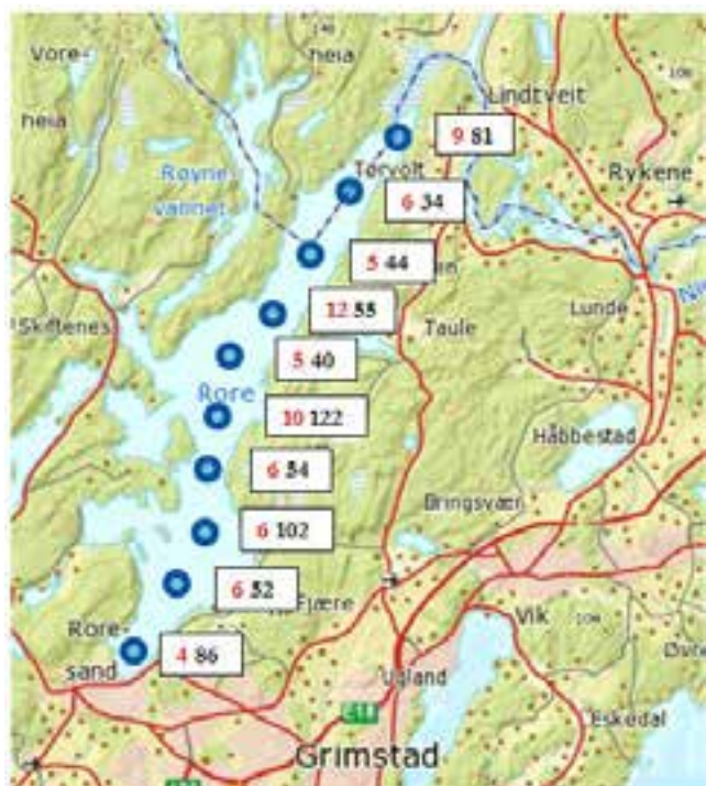
Figur 12. Konsentrasjon (most probable number/100 mL) av bakterier i Rore den 23.9.2015. Tall i rødt til venstre er E. coli , mens tall til høyre er koliforme bakterier. Inntaket til Grimstad vannverk ligger litt sør for punktet med bakterietallene 6,52 i figuren, mens inntaket for Arendal vannverk ligger mellom punktene 6,34 og 5,44.
