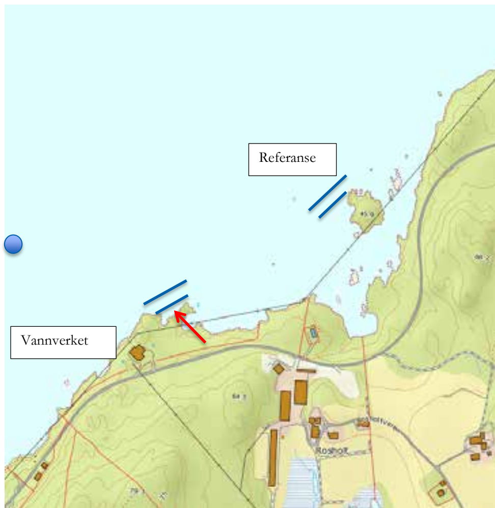
Figur 2. Vannverket, utslippspunktet (rød pil) og området for videofilming (mellom blå linjer). Avstanden til referanseområdet for videofilming er 350 meter. Verkets vanninntak (EU89: L 8.5494, B 58.3617) er på 38 meters dyp og ligger 300 meter utenfor utslippspunktet. Inntaket er markert med blå ring. Kartkilde: norgeskart.no.
