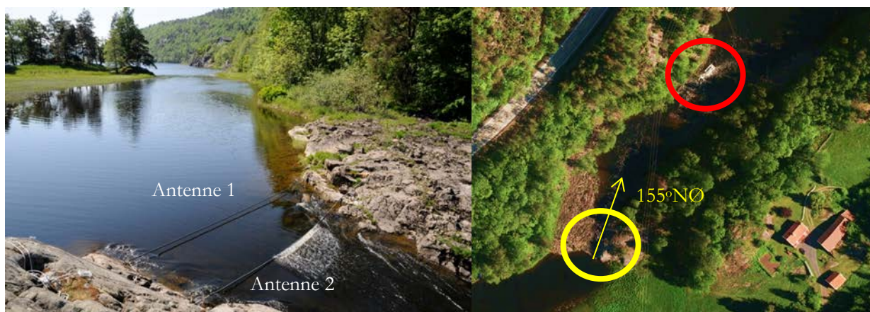
Figur 3. PIT-1870 besto av to antenner, hvor antenne 1 var oppstrøms. Antennene er trukket på tvers av elva og er 9 m lang og ca 1 m høy. Her benyttes stående antenner. Kart over lokalisert av PIT-1870. I bildene er PIT antenna innenfor den gule sirkelen mens smolthjulet i Strømmen er innenfor den røde sirkelen. Retning på elva forbi PIT-antenna er angitt
