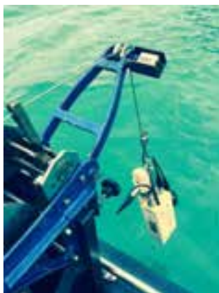
Figur 5. CTD sonde benyttet for måling av temperatur og konduktivitet i vannsøylen
