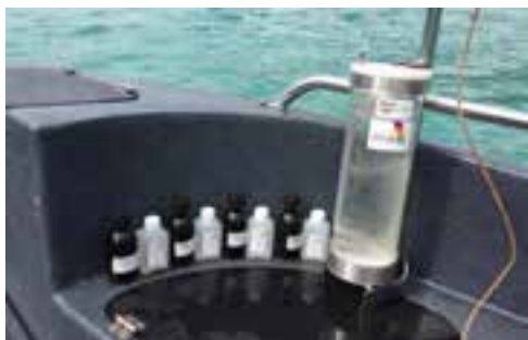
Figur 4. Limnos vannhenter benyttet for vannprøvetaking (Foto: NIVA)
