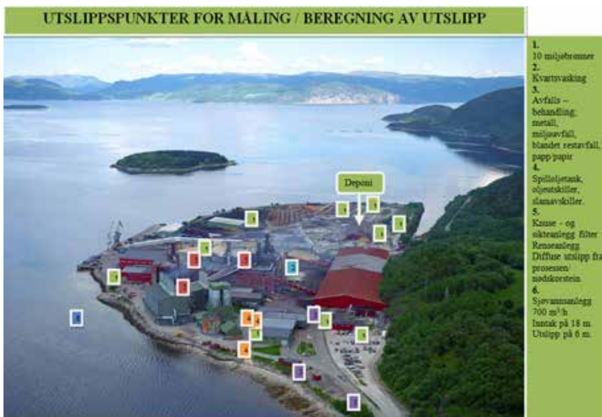
Figur 2. Kart med detaljer for bedriftsområdet til Wacker Chemicals. Utslippspunktet er på 6 m dyp. Kartet er laget av Wacker Chemicals.
