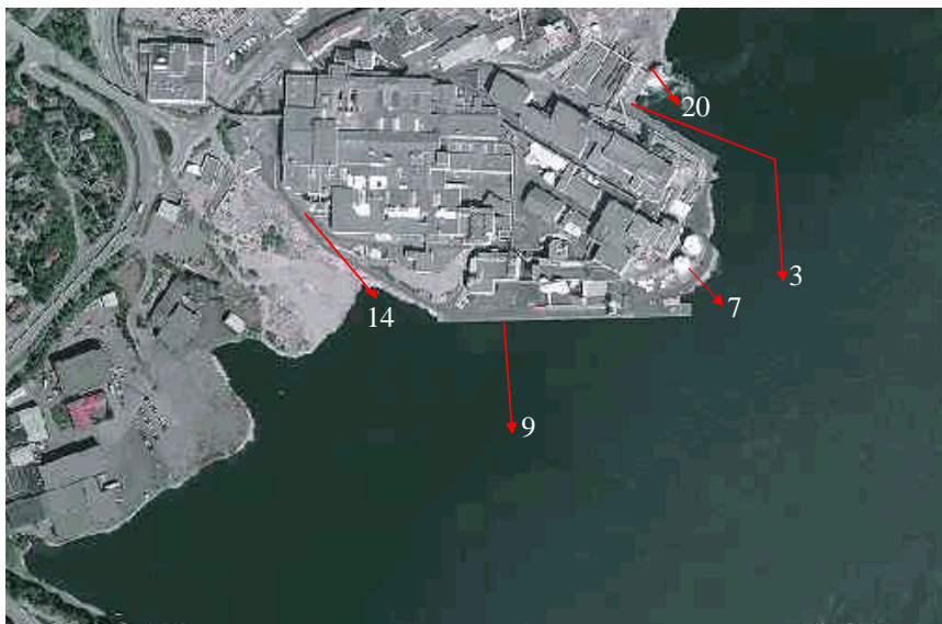
Figur 4. De fem utslippspunktene for prosessvann fra Glencore Nikkelverk AS er markert som punkt 3, 7, 9, 14 og 20 (fra Næs og Håvardstun 2013). Avløpsvann fra utslippspunktene 14 og 20 slippes ut på ca. 1 m dyp, mens avløpsvann fra utslippspunktene 3, 7 og 9 slippes ut på ca. 21 til 23 m dyp.
