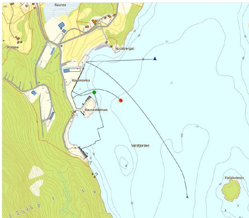
Figur 4. Utslippspunktene for RO-vann (grønt) og det kommunale kloakkutslippet (rødt) i Raunesvika. Inntaksledninger for sjøvann til Raunes Fiskefarm er også markert (trekanter).
