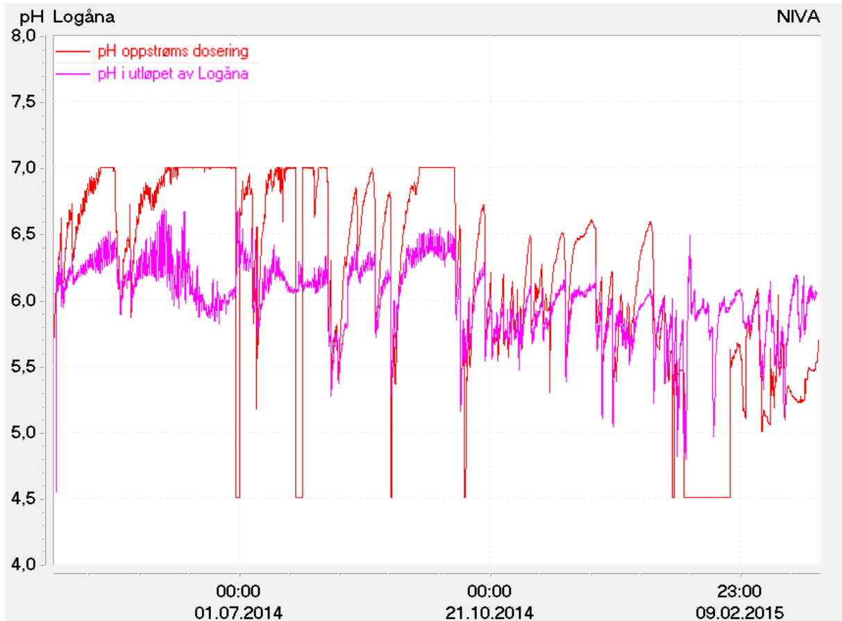
Figur 3. pH oppstrøms anlegget og ved utløpet av Logåna. Det er svært dårlig samsvar mellom disse pH-verdiene, og pH er tilsynelatende hovedsakelig lavere etter dosering. pH > 7 og < 4,5 måles ikke.
