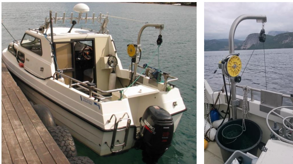
Figur 4: Båt med løftekran og linehaler som ble brukt til pelagisk prøvetaking i de syv store innsjøene i basisovervåkingsprogrammet ØKOSTOR i 2015.
