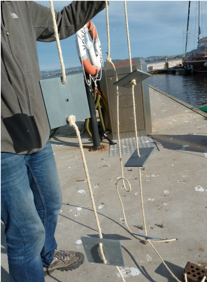
Figur 2. Bildet viser hvordan tre begroingsplater ble hengt opp på hvert tau, enten vertikalt eller horisontalt, på 1, 1,5 og 2 m dyp.
