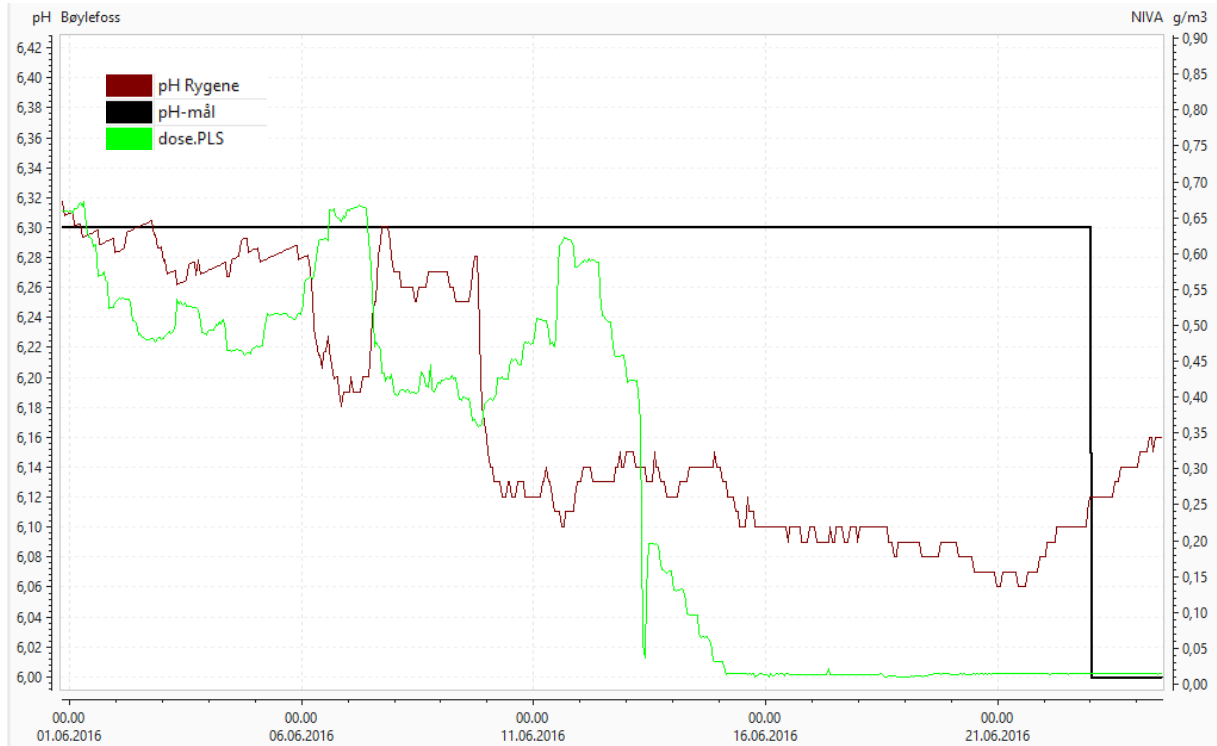
Figur 2. pH på Rygene, pH-målet og PLS-dose på Bøylefoss doseringsanlegg i juni 2016. Doseringen ble redusert for tidlig til å kunne opprettholde pH-målet.
