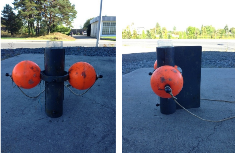
Figur 2. Sedimentfelle sett forfra og fra siden (Foto: Jarle Håvardstun, NIVA).
