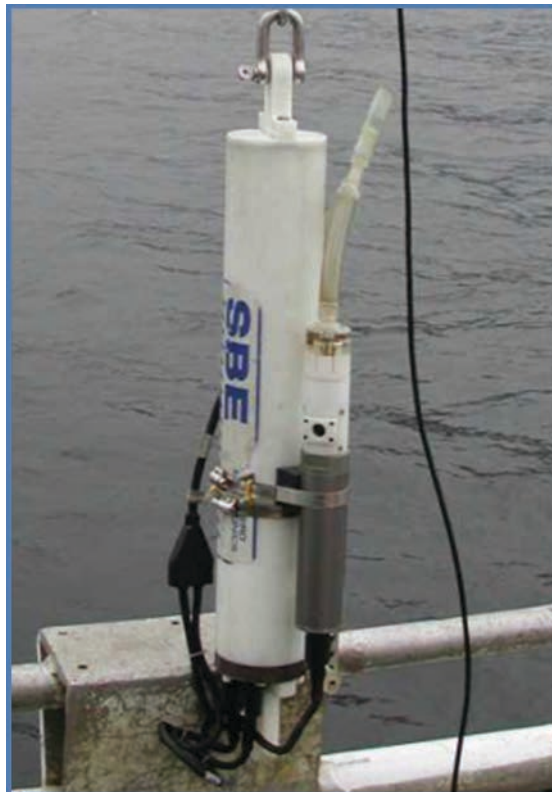
Figur 2.3 Seabird SBE-19 CTD målesonde som ble benyttet på toktene, supplert med måling med en RBR Concerto sonde (ikke avbildet).
