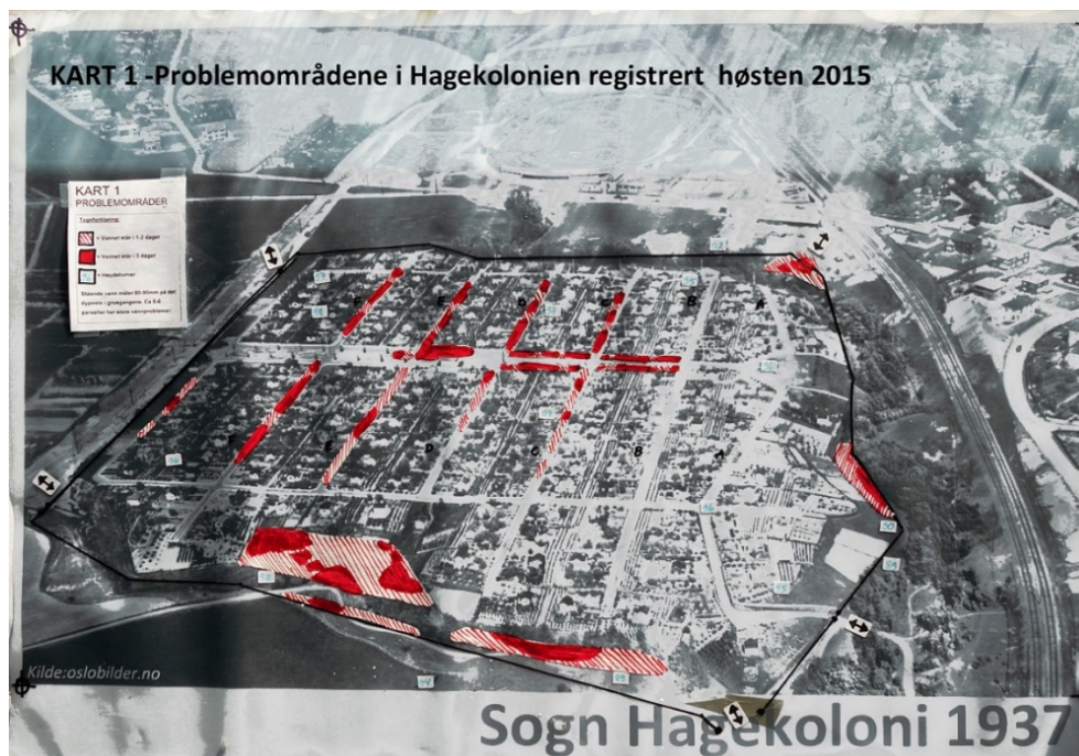
Figur 5. Manuelle registreringer foretatt høsten 2015 av to av hagekolonistene ved observasjon og måling med metermåle i hagen ved regn. De helrøde områder er hvor vannet står mer enn 3 dager etter regnskyll, de skraverte 1-2 dager. De fant at stående vann målte 80-90 mm på det dypeste i grusgangene. Kilde: kart utarbeidet av Adriana Bertet (gjengitt med tillatelse).
