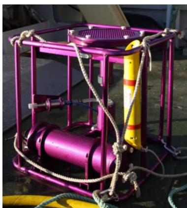
Figur 5. Høyvolumsvannprøvetakeren («Miss Pinky») som ble benyttet til prøvetakning i Frierfjorden. Her ble 300 L vann prøvetatt fra 43, 57 og 96 meters dyp og filtrert gjennom et 0,7µm glassfiberfilter som ble analysert for dioksiner (Allan, Schaanning, og Beylich 2011).
