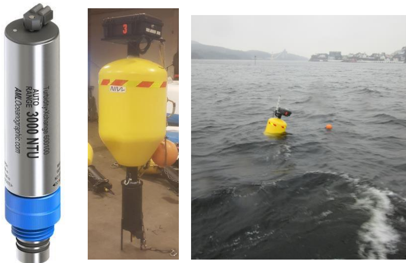
Figur 4. Turbiditetssensor og bøye brukt i overvåkingen (Foto: Medyan Antonsen og Sigurd Øxnevad).
