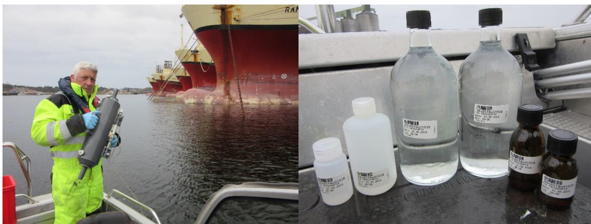
Figur 7. Vannprøver ble tatt ved hjelp av en Niskin vannhenter (bildet til venstre). Vannprøvene ble fordelt på flere flasker (bildet til høyre). Det var egne flasker for vannprøver til analyser for metaller, metylkvikksølv, PCB og PAH16, TBT og TOC. Foto: Sigurd Øxnevad.
